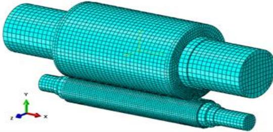
Рис.4. Конечно-элементная модель валковой системы 4-клетевого стана
